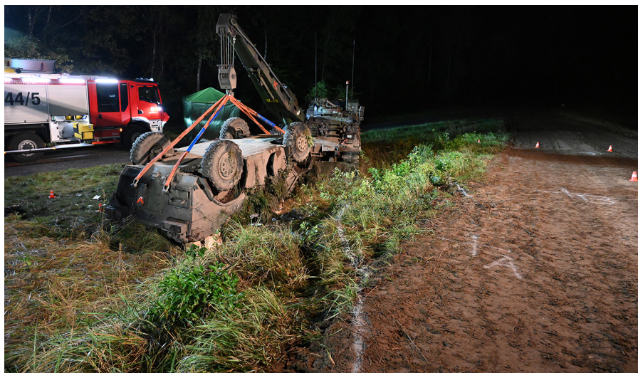
Figuur 18: Foto genomen tijdens de berging van het voertuig. De Fennek is opgetakeld door het bergingsvoertuig (de Buffel) met op de voorgrond met een witte lijn gemarkeerd het door het voertuig gecreëerde linker- en rechterspoor (foto: Forensische Opsporing Verkeer & Visualisatie Koninklijke Marechaussee)
