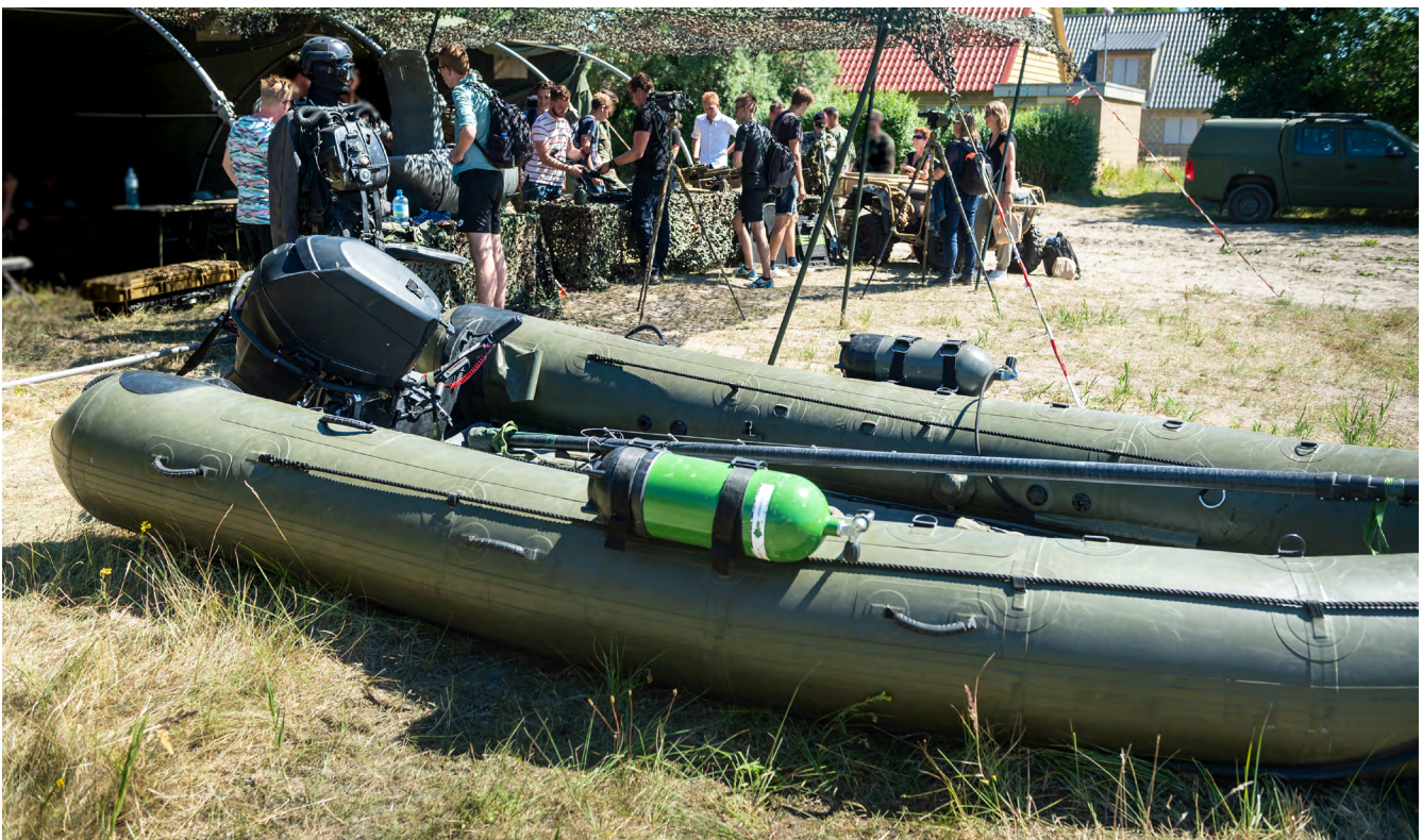
Figuur 7 DeBatts Rubber Rigid Inflatable Boat 5.20m zoals te zien bij de Infodag Korps Mariniers (Bron: Defensie)
