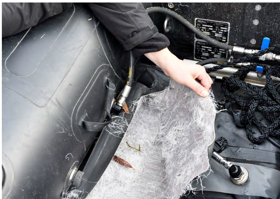
Figuur 6 Plaats waar de bodem is uitgescheurd (bron: IVD)
