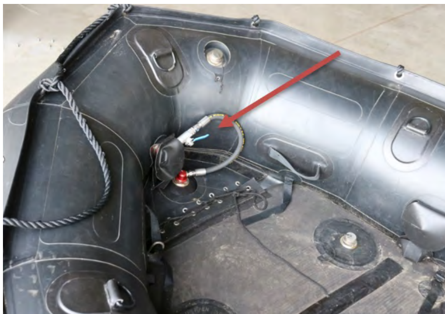
Figuur 3 Afsluiter in de boeg van een onbeschadigde Zodiac (bron: IVD)
