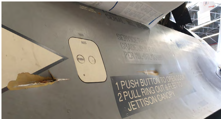
Figuur 7 Schade aan het plaatwerk (bron: IVD).
