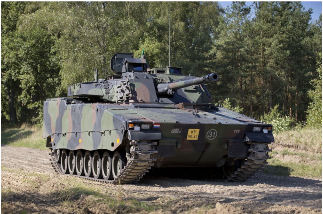
Afbeelding 1 CV90: lengte 6,47m, breedte 3,01m en hoogte 2,83 (tot hoogste punt koepel). Bron: Defensie.
